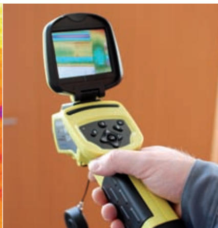
Suche nach Leckstellen mit Infrarotkamera
